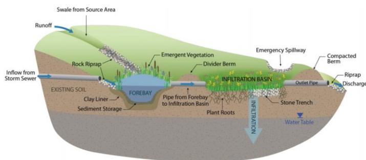
Figure 9 Infiltration basin (Geosyntec)
